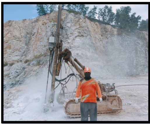
รูปที่ 2-19 เครื่องเจาะแรมี่ที่ตักฝุ่นและพนักงานใส่ชุด safety
